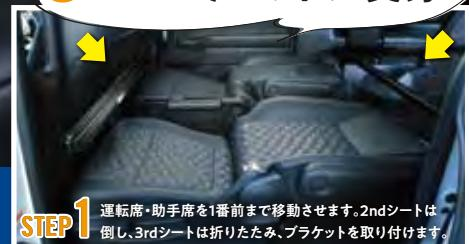
STEP1 運転席・助手席を1番前まで移動させます。2ndシートは倒し、3rdシートは折りたたみ、ブラケットを取り付けます。
